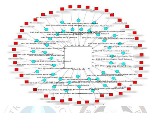
經過 Arcsight 收容前端 IPS 資料後,進行後續的關聯分析,產出如上攻擊拓撲圖,可了解此種攻擊行為的模式及其關連性。其中紅色方形代表攻擊發動者,藍色圓形表示攻擊事件類型,而白色方形代表攻擊目的端主機,圖形的大小代表攻擊量的多寡,綜合以上資訊,可以發現 DNS 放大攻擊模式具有多攻擊來源、單一目標、及龐大數量等特性。在此模式下,目標主機若沒有相關防護措施,網路環境很容易被攻擊造成網路癱瘓。
