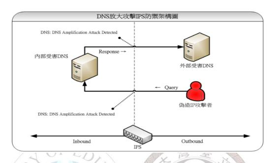
北區 ASOC 透過 IPS 即時監測各區網中心是否有 DNS 放大攻擊事件,偵測基本架構可參考上圖,透過於網路骨幹中的 IPS,同時檢測 Inbound及 Outbound的流量,一旦有外部攻擊者發出偽造來源的惡意 DNS 封包或內部 DNS 主機發出異常 query 封包時,皆可被 IPS 偵測到,避免 DDoS攻擊之情事發生,在此種偵測模式下,我們可以確保轄下連線單位內的 DNS不被外部惡意攻擊者所利用,同時,也能確保內部不受到此種攻擊模式危害,在大規模攻擊情事發生前,亦能提早發出告警,避免攻擊進一步擴大而影響整體網路環境。
